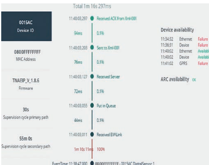
Abb. 3: Alarmübertragungszeit einer Alarmanlage
